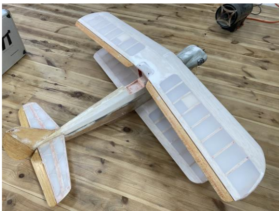
Nach der Neubespannung mit Bügelgewebe. Die Beplankung der Tragflächen wurde komplett erneuert!
